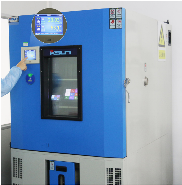
图 5-3 高低温老化测试图
